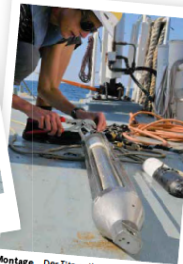
Montage Der Titanzylinder mit Empfängerlektronik wird in die Empfängerkette eingebaut.
